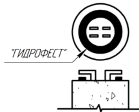
Установка жгута ГИДРОФЕСТ по окружности сваи
